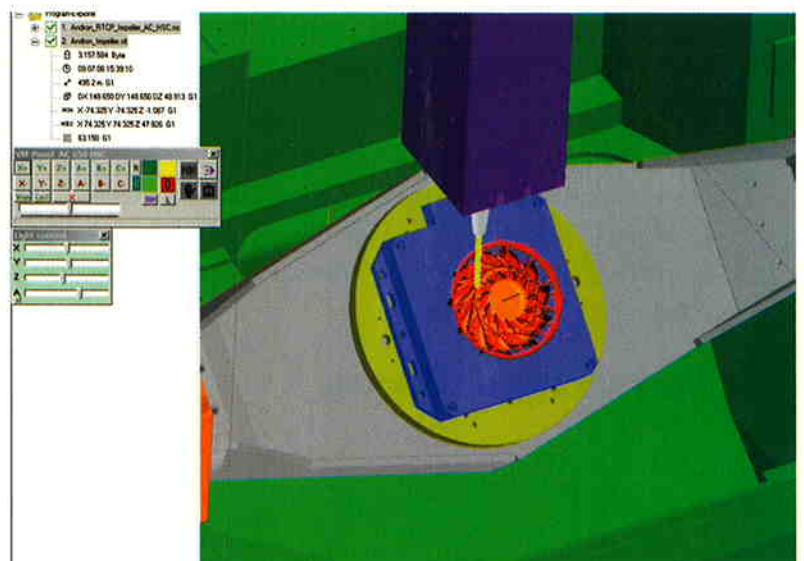
Vor dem Fräsen des Impellerrades können mit Hilfe der Virtual Machine ungewollte Kollisionen verhindert werden. Rechts: Die roten Linien verdeutlichen die vom NC-Programm festgelegte Fräsbahn, die das Werkzeug abarbeiten soll.
