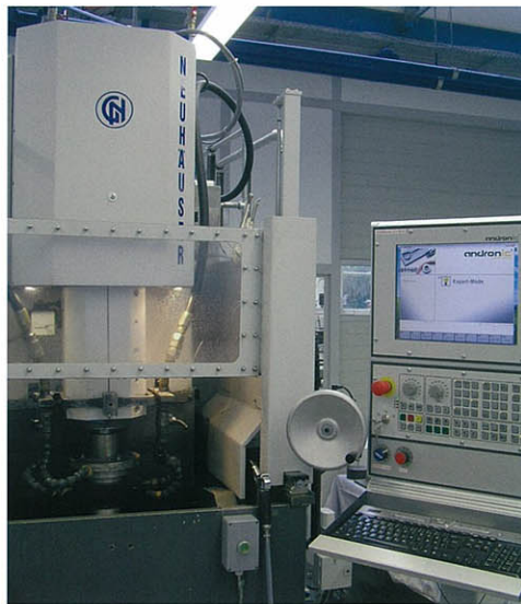
Bild 2: Die Neuhäuser Präzisionswerkzeuge GmbH verwendet zur Herstellung ihrer Sonderwerkzeuge selbst gebaute und firmenintern programmierte Maschinen, die mit einer CNC-Steuerung ausgestattet werden. Die hier abgebildete Planschleifmaschine dient zum Plan- und Hohl-schleifen von scheibenförmigen Zerspanungswerkzeugen
